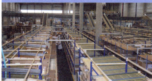
Dans le circuit de préparation colis, l'opérateur dispose d'un ensemble autoporté mobile sur un système de rails horizontaux, comprenant terminal informatique et imprimante.
