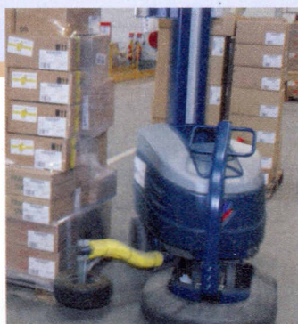
Les palettes sont ensuite filmées par des robots automatiques qui, outre le gain de place, permettent d'économiser jusqu'à 40 % en consommables.
