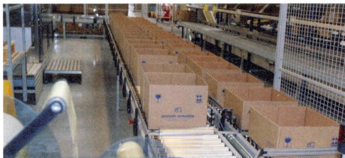
Lors du lancement des vagues de préparation, le système choisit entre les deux formats de carton disponibles en fonction de la commande.
