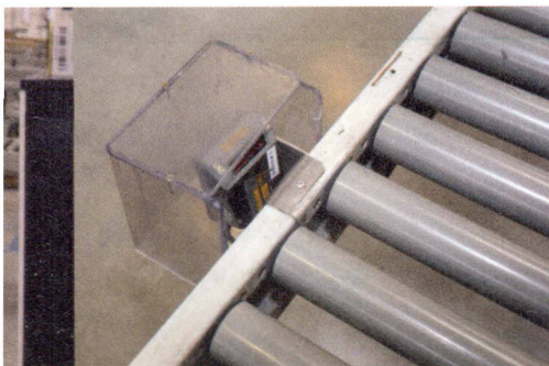
Le site expédie en moyenne 11 400 colis/jour dont 200 colis froids. L'opérateur peut réaliser deux palettes à la fois, chaque colis prélevé étant décramenté, avant d'être déposé sur la palette adéquate, au moyen d'un lecteur optique implanté en bout de chaîne.
