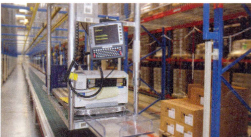
Dans le circuit de préparation colis, l'opérateur dispose d'un ensemble autoporté mobile sur un système de rails horizontaux, comprenant terminal informatique et imprimante.
