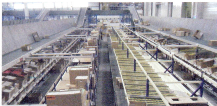
Dans l'ancienne installation, l'évacuation des cartons vides s'effectuait par l'intermédiaire d'un convoyeur aérien.
